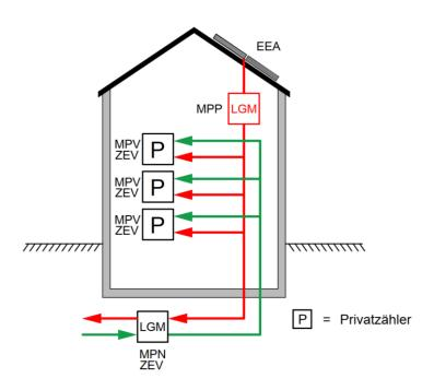
EEA: Energieerzeugungsanlage MPP: Messpunkt Produktion
