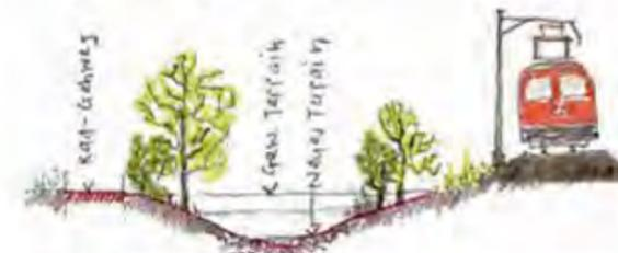
Zielbild: Querschnitt Krebsbach, verlegt an den Bahndamm mit neuem Rad- und Gehweg
